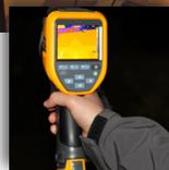
Grâce aux couleurs, la caméra thermique permet de bien visualiser déperditions de chaleur et ponts thermiques
