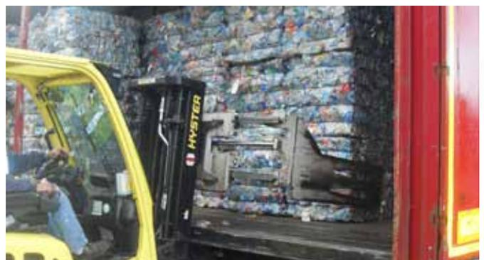
Une fois triés, les emballages recyclables sont conditionnés par matériau sous forme de balles et expédiés vers différentes usines de recyclage
