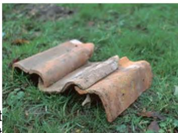
Leur toit est traditionnellement recouvert de tuiles flamandes au profil en « S ».
